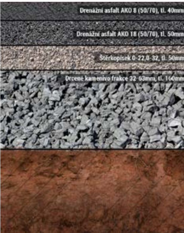
↑ Mlatový povrch - referenční obrázek ↓ Drenážní asfalt - souvrství
